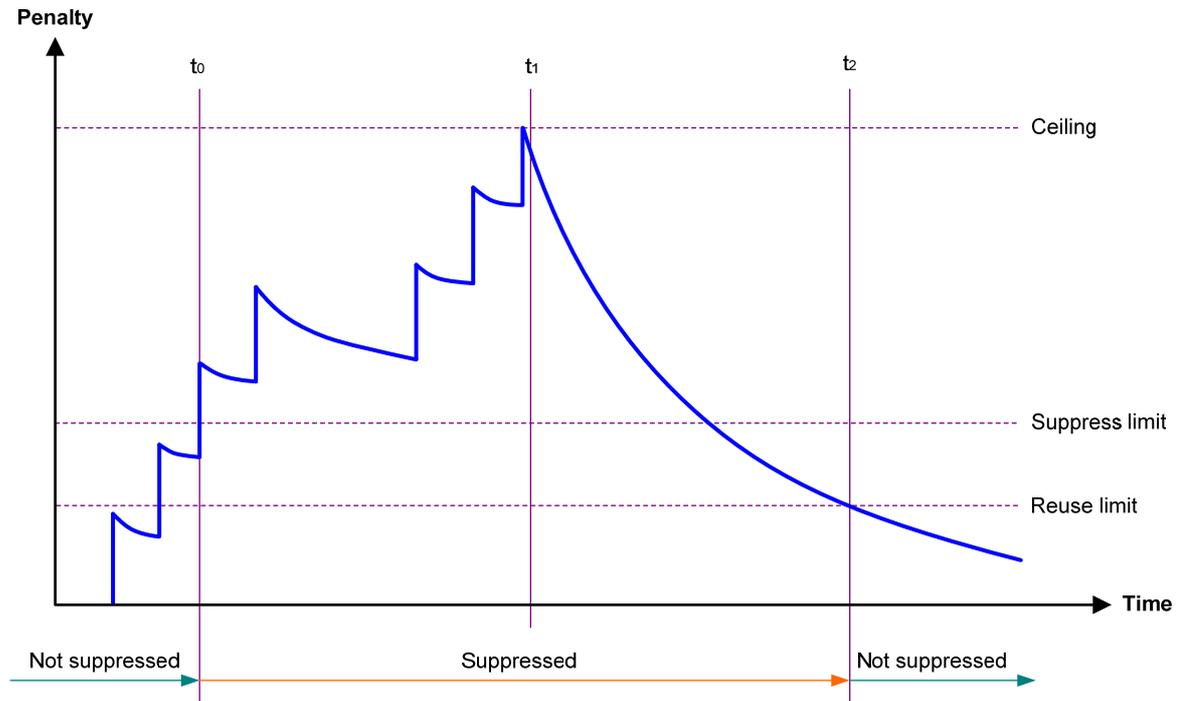
图 1-1 中,  $t_0$  为抑制开始时间, 从  $t_0$  开始经过最大抑制时间后达到  $t_1$ ,  $t_2$  为抑制结束时间。  $t_0$  至  $t_2$  段对应接口抑制期,  $t_0$  至  $t_1$  段对应最大抑制时间,  $t_1$  至  $t_2$  段对应完全半衰期 (此阶段惩罚值不再增加)。
